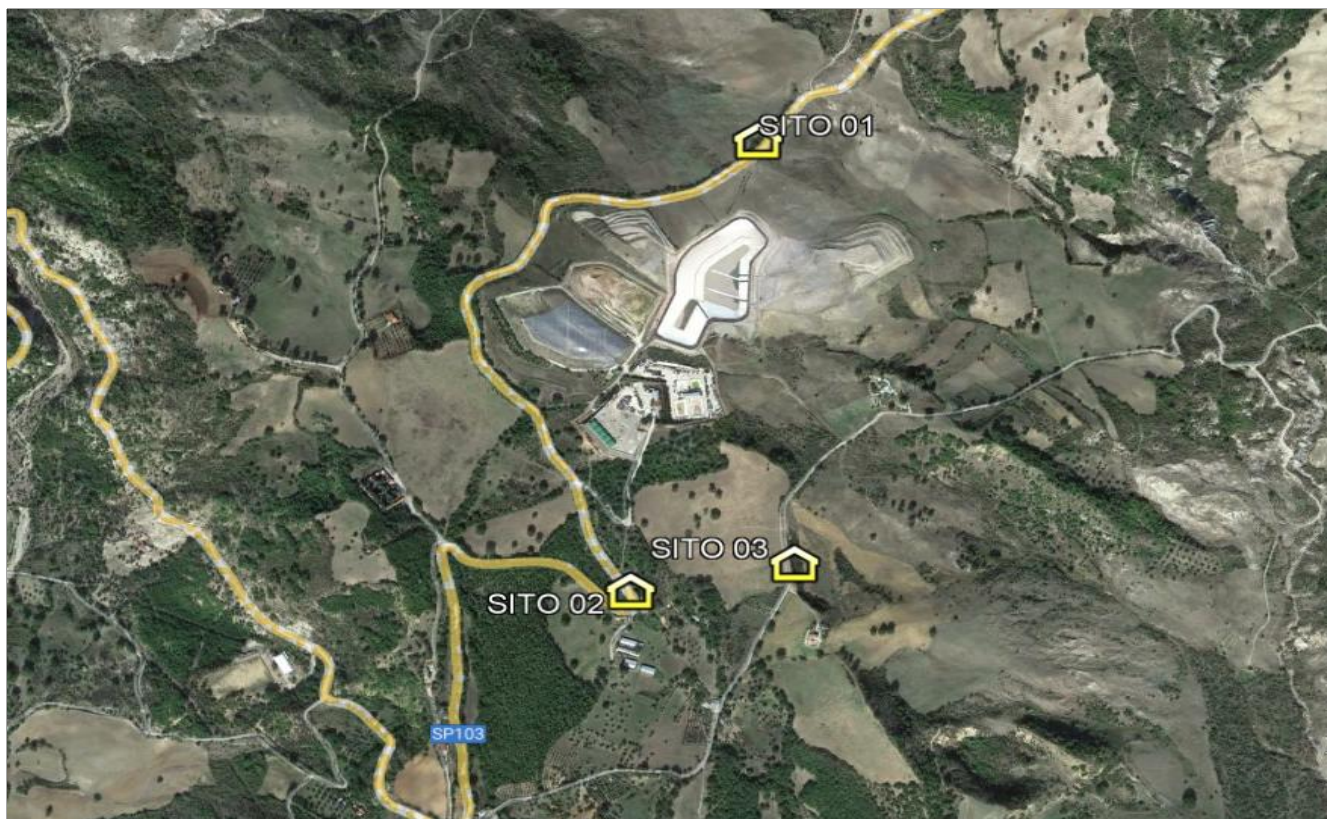
Figura 2.1 – Rete di monitoraggio dell'H 2 S area Semataf: localizzazioni delle stazioni di campionamento
