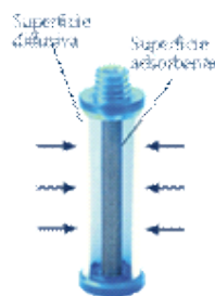
Figura 3.3 - Campionatore passivo Radiello
